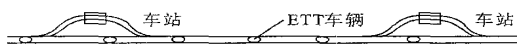
图 2 真空管道运输线路及车站布局图 Fig. 2 Layout of ETT track and stations
