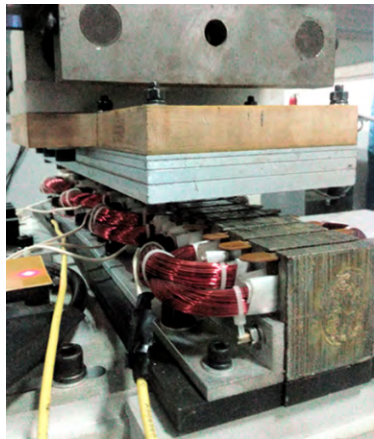
(a) 20 mm 厚次级起动推力测试
