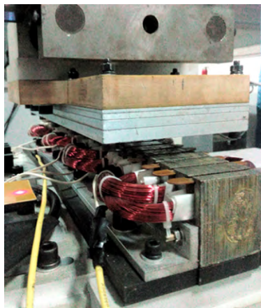
(a) 20 mm 厚次级起动推力测试
