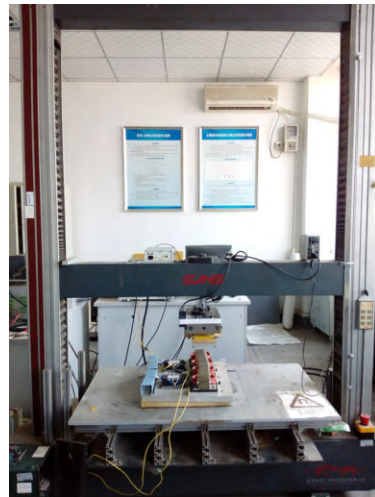
(b) 直线电机试验段测试台
